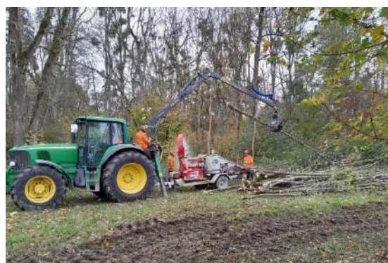
Figure 11 - Tracteur avec le broyeur à branches qui projette ensuite les copaux en lisière
